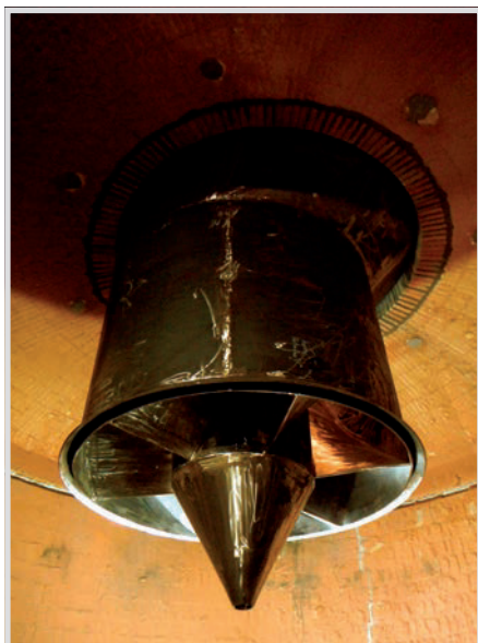
Bild 5. Exzentrisches Tauchrohr am Einsatzort im Zyklon.
