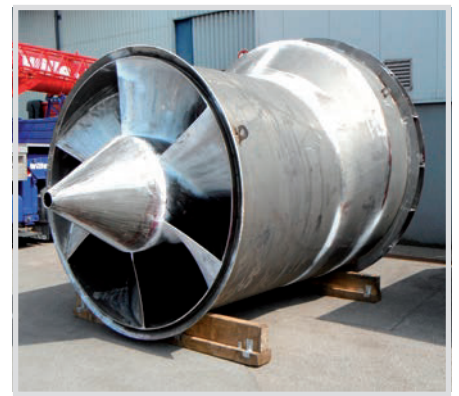
Bild 3. Montagebereites Tauchrohr mit Leitapparat. Das Bauteil wurde liegend zwischengelagert. Zum Transport wurden Ösen angeschweißt.
